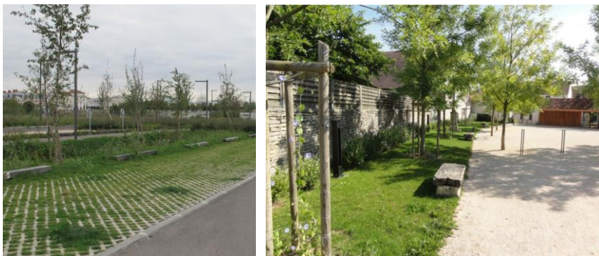
A gauche : exemple d'aire de stationnement engazonnée A droite : exemple de place végétalisée et non imperméabilisée
