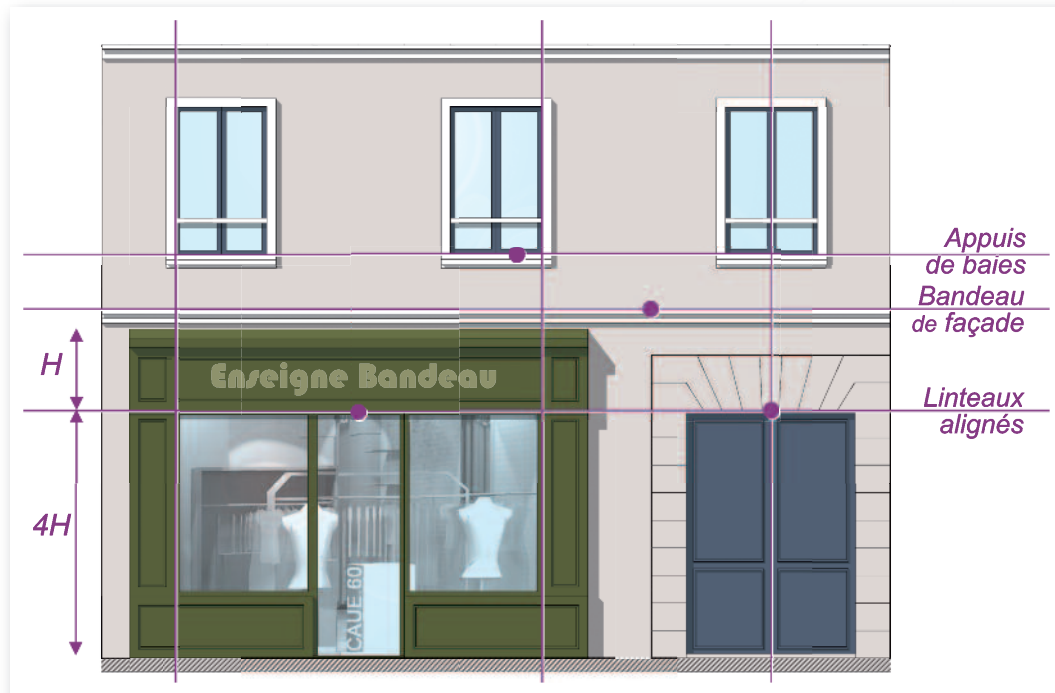
Principe d'une devanture en applique sur une façade d'ordonnement type
